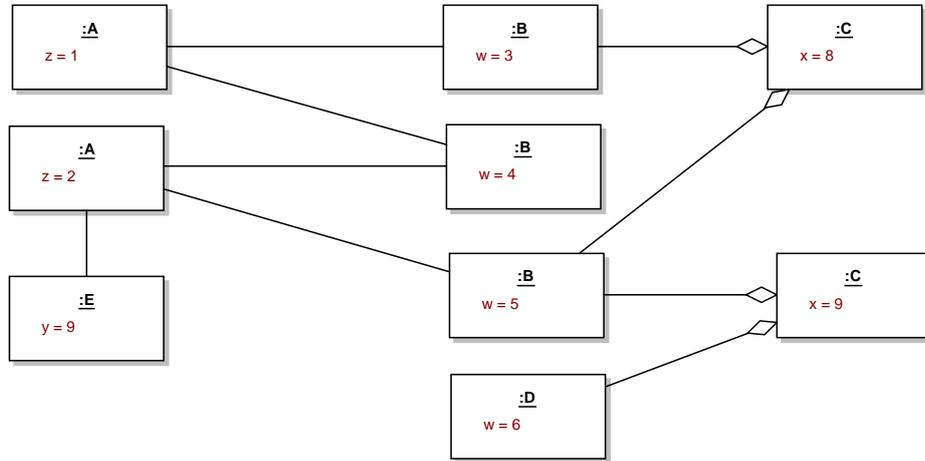
Entwerfen Sie ein Klassendiagramm zudem dieses Objektdiagramm konform ist. Beschriften Sie die Kardinalitäten der Beziehung entweder mit 1 oder \* (=n). Sie können davon ausgehen, dass dieses Objektdiagramm die höchstzulässige Anzahl an Beziehungen mit Objekten einer anderen Klasse darstellt. Weiters soll, wenn möglich, auch eine Generalisierung durchgeführt werden.
